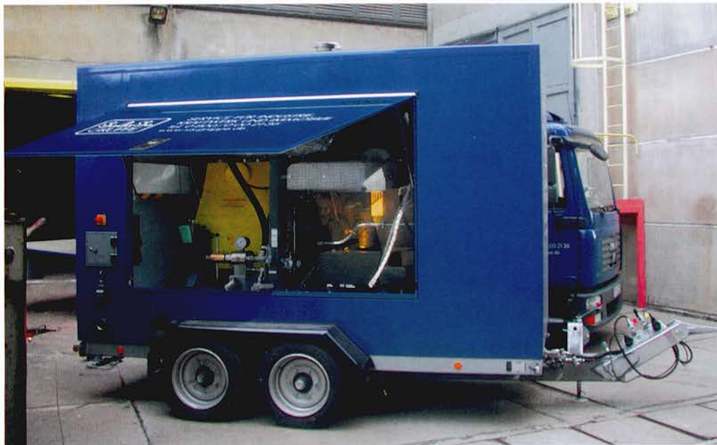
Zur S.I.S.-Ausrüstung für eine Druckprüfung gehören unter anderem ein mobiler Pumpcontainer, eine Höchstdruckanlage, Druckleitungen, Messaufnehmer und Steuerungstechnik sowie ein hochtechnologisiertes Computersystem.
