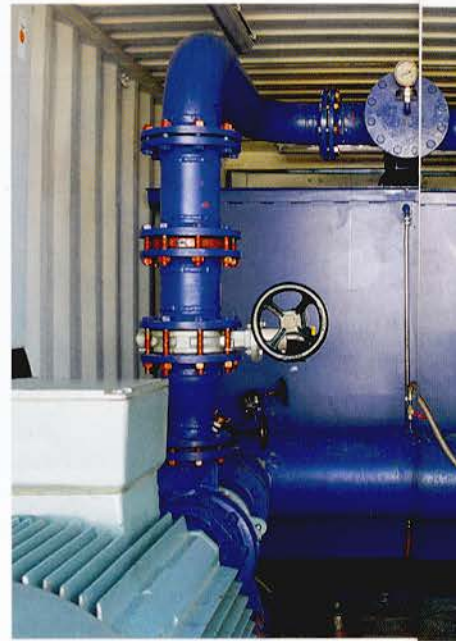
Zur S.I.S.-Ausrüstung für eine Druckprüfung gehören unter anderem ein mobiler Pumpcontainer, eine Höchstdruckanlage, Druckleitungen, Messaufnehmer und Steuerungstechnik sowie ein hochtechnologisiertes Computersystem.
